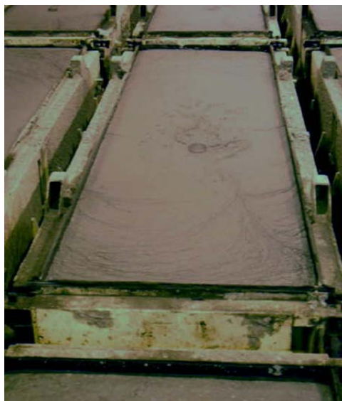
شکل ۱-۴- افزایش حجم کیک خام در قالب
